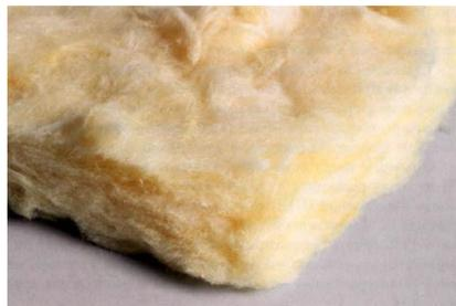
Стекловолоконная вата материал, состоящий из беспорядочно расположенных стеклянных волокон, полученных из расплавленного сырья. Сырьем для производства стекловаты служит сырьевая шихта для варки стекла (кварцевый песок, кальцинированная сода и сульфат натрия) или стекольный бой. Производство стекловолоконной ваты и изделий из нее состоит из следующих технологических процессов: варка стекломассы в ваннах печей при 1300-1400°C, изготовление стекловолокна и формование изделий.
