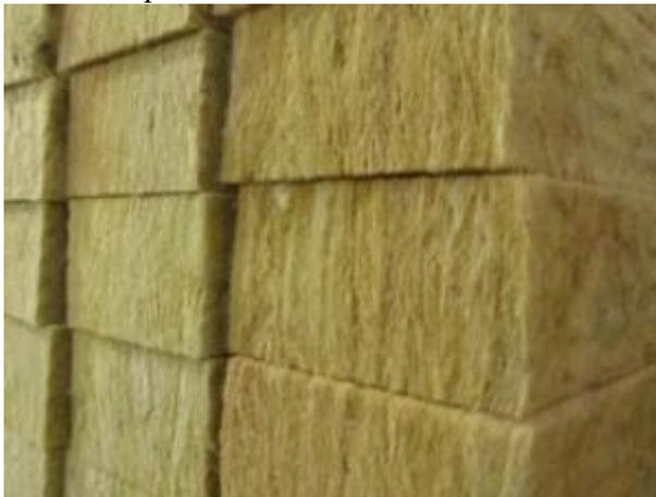
Минеральная вата и изделия из нее. Минеральная вата волокнистый теплоизоляционный материал, получаемый из силикатных расплавов. Сырьем для ее производства служат горные породы (известняки, мергели, диориты и др.), отходы металлургической промышленности (доменные и топливные шлаки) и промышленности строительных материалов (бой глиняного и силикатного кирпича).
